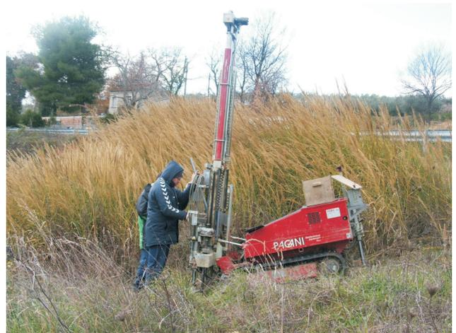
Postazione prova penetrometrica CPT2
